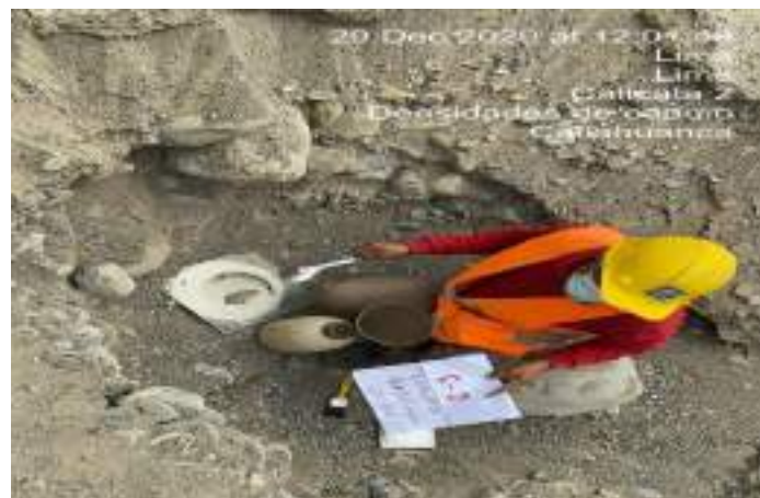
Figura 20: Ensayo de densidad en calicata N°1 Fuente: Elaboración propia
