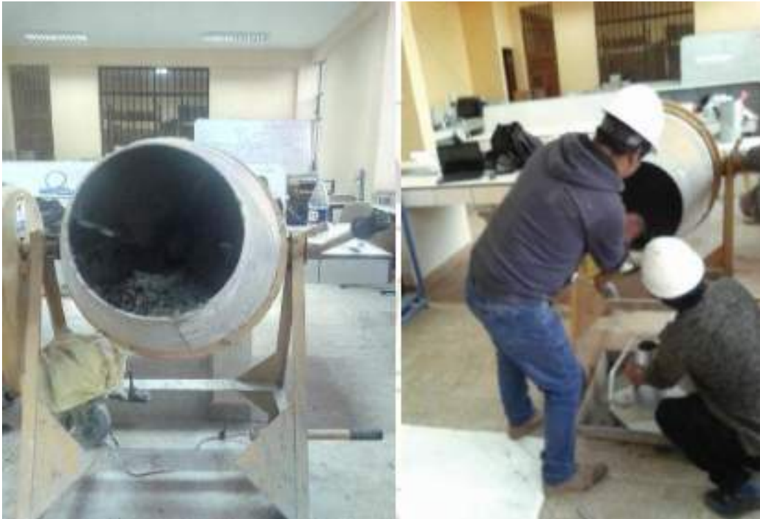
Imagen 03: Preparación de la mezcla para las probetas con la mezcla de concreto.
