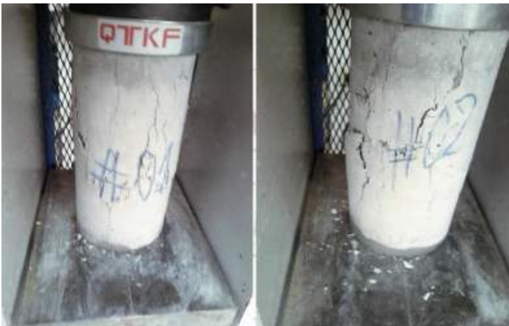
Imagen 04: Ruptura de probetas con mezcla de concreto después de 28 días de curado.
