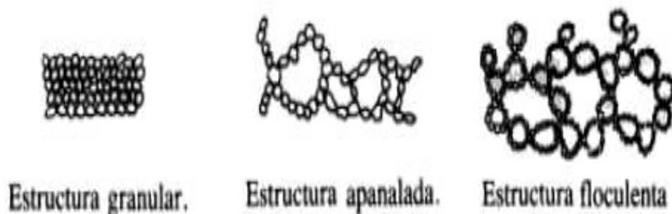
Figura 3. Estructura del suelo en Mecánica de suelos y cimentaciones. Crespo (2004)
