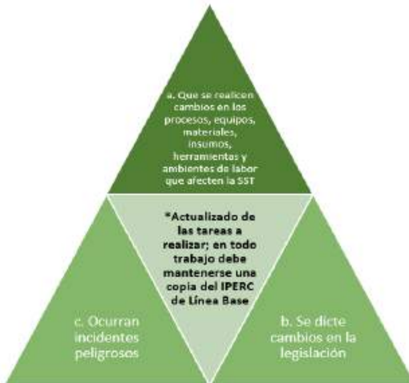
Figura 9: Condiciones Línea Base IPERC Fuente: Diseño Propio
