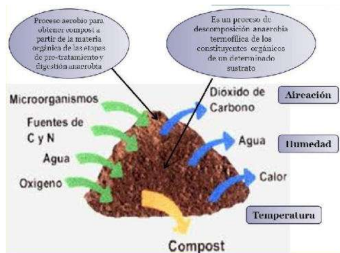
Figura 14: Diagrama de una pila para elaborar compost, alimento de la lombriz roja californiana
