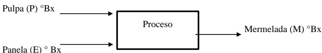
El balance de materia es importante en el cálculo de un proceso para ver las entradas y salidas realizadas, así como el rendimiento del producto final (mermelada). El balance puede ser aplicado de manera general o de la operación unitaria que interviene en el proceso de elaboración (Deiana *et al.*, 2018).
