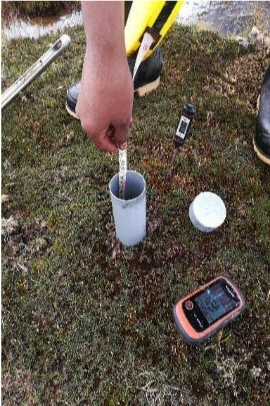
Fotografía 4.5: Toma y registro de datos físico-químicos en la zona del canal de drenaje
